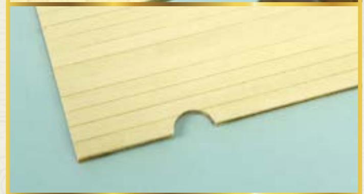
**11** Обработайте обрезанные края планок круглым или полукруглым надфилем. В этом случае также работайте надфилем только по направлению к детали (79А).
